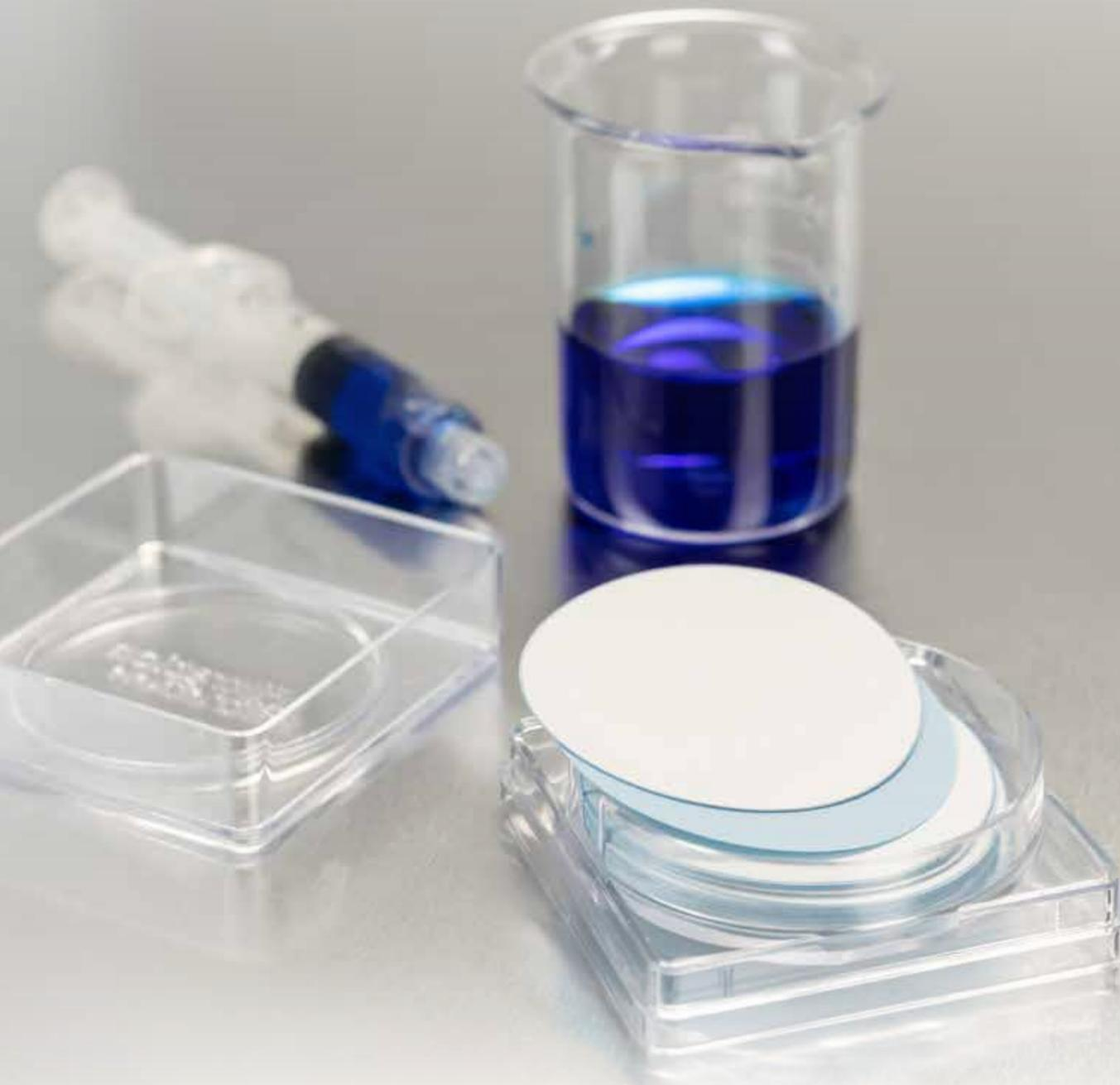
**i** Nylon Membranfilter sind hydrophil und eignen sich gut zur Klarfiltration von Puffern und Nährmedien mit einer geringen Anzahl extrahierbarer Bestandteile.
