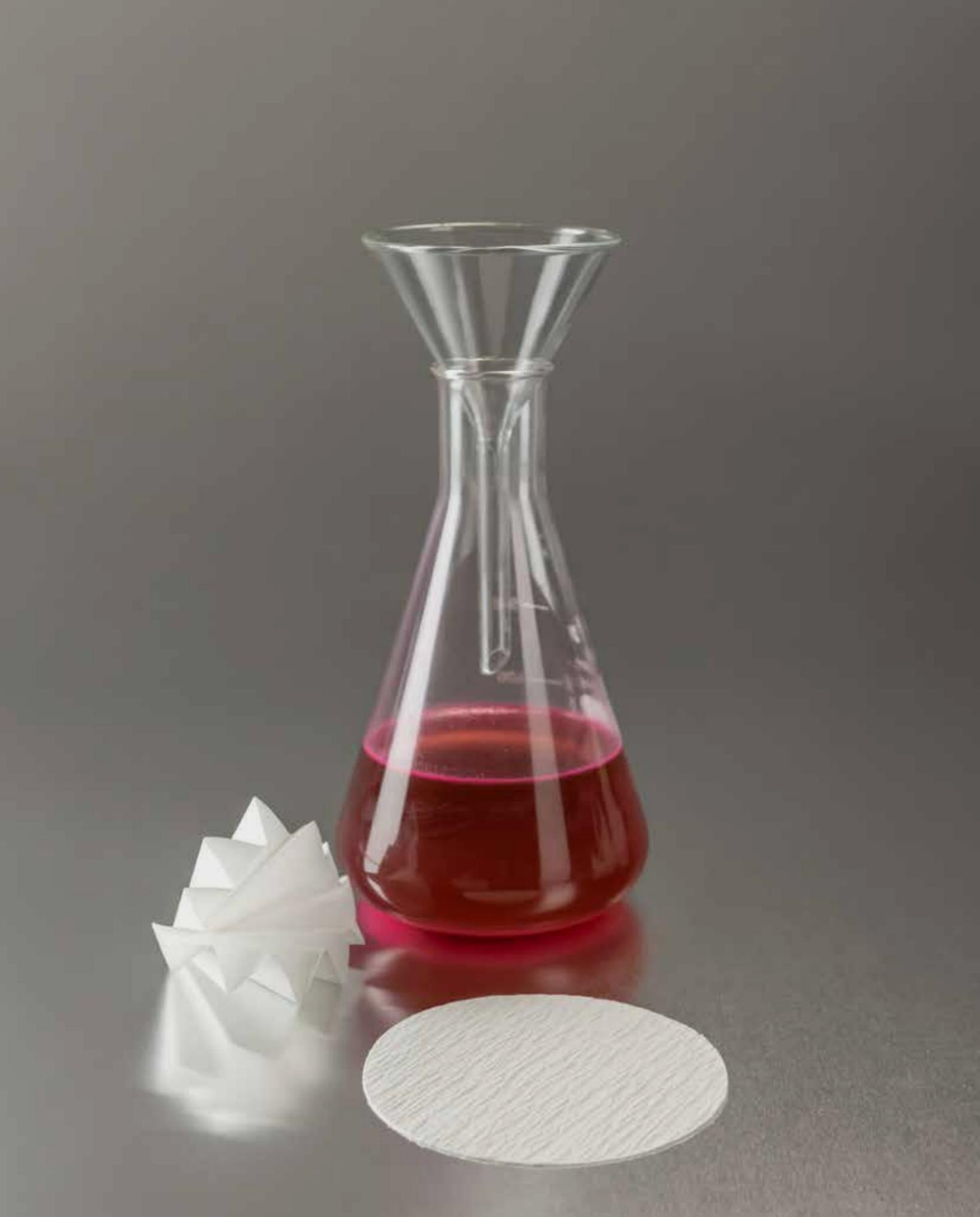
**i** Gekreppte Filterpapiere haben eine besonders große Oberfläche und entsprechend kürzere Filtrationszeiten.
